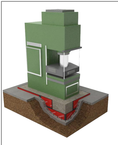
MACHINE ISOLATIE OP ZWEVENDE FUNDERING
