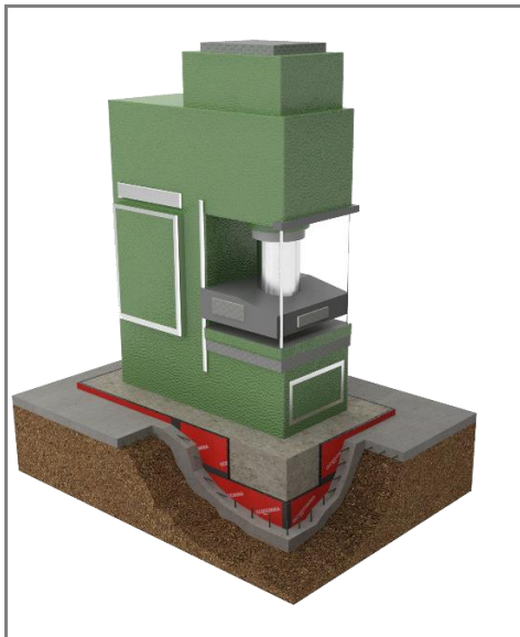
MACHINE ISOLATIE OP ZWEVENDE FUNDERING
