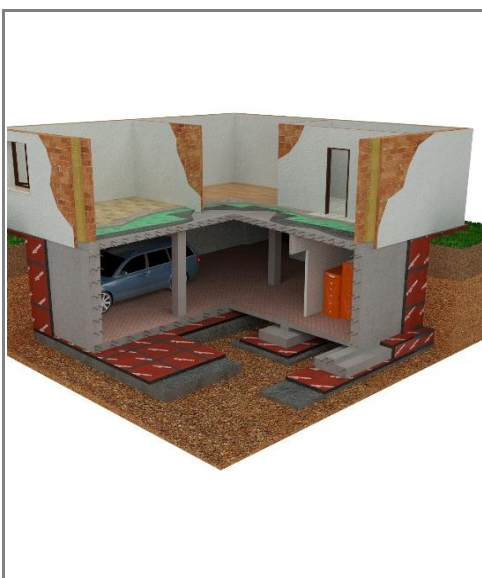
ISOLIERUNG VON FUNDAMENTEN
