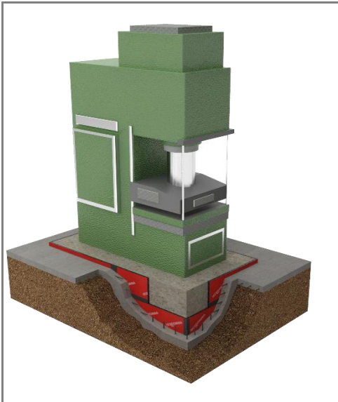
ISOLIERUNG VON MASCHINEN AUF SCHWIMMENDEM FUNDAMENT
