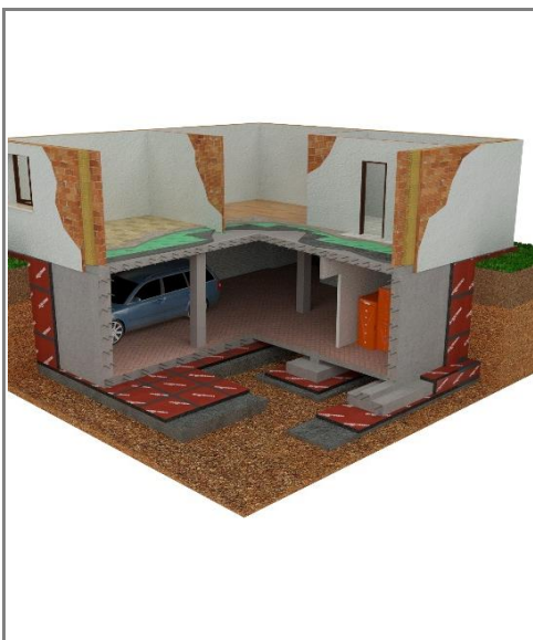
ISOLIERUNG VON FUNDAMENTEN
